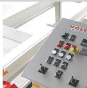
Ergonomisches Bedienpult mit Längenanzeige
